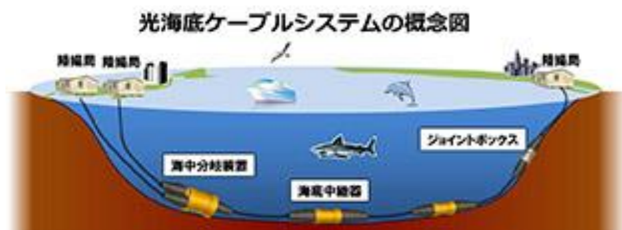
図 2 光海底ケーブルシステム概要図
